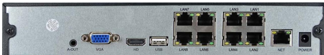
**A-OUT** - A questo connettore minijack puoi collegare un altoparlante esterno per diffondere l'audio. Ricorda che l'uscita monitor HDMI conduce anche l'audio per cui se colleghi una TV via HDMI puoi sentire l'audio senza collegare questa uscita.
