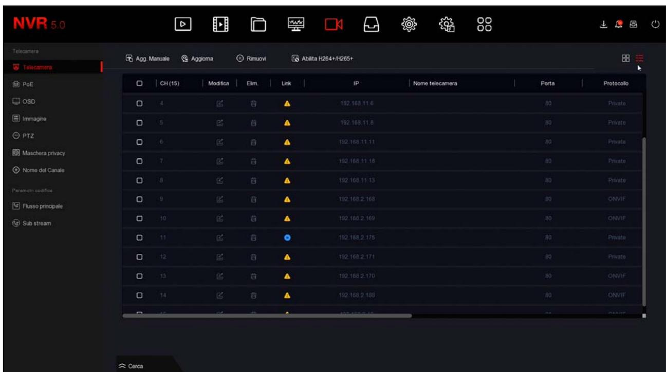
Una volta assegnato l'IP alla telecamera, collega la telecamera a una porta POE del NVR, clicca MODIFICA nel canale a cui hai collegato la telecamera e cambia la modalità di aggiunta da Plug&Play a MANUALE, con protocollo ONVIF. Poi completa la scheda con le credenziali di accesso della telecamera e l'indirizzo IP che hai assegnato alla telecamera, come nel seguente esempio.
