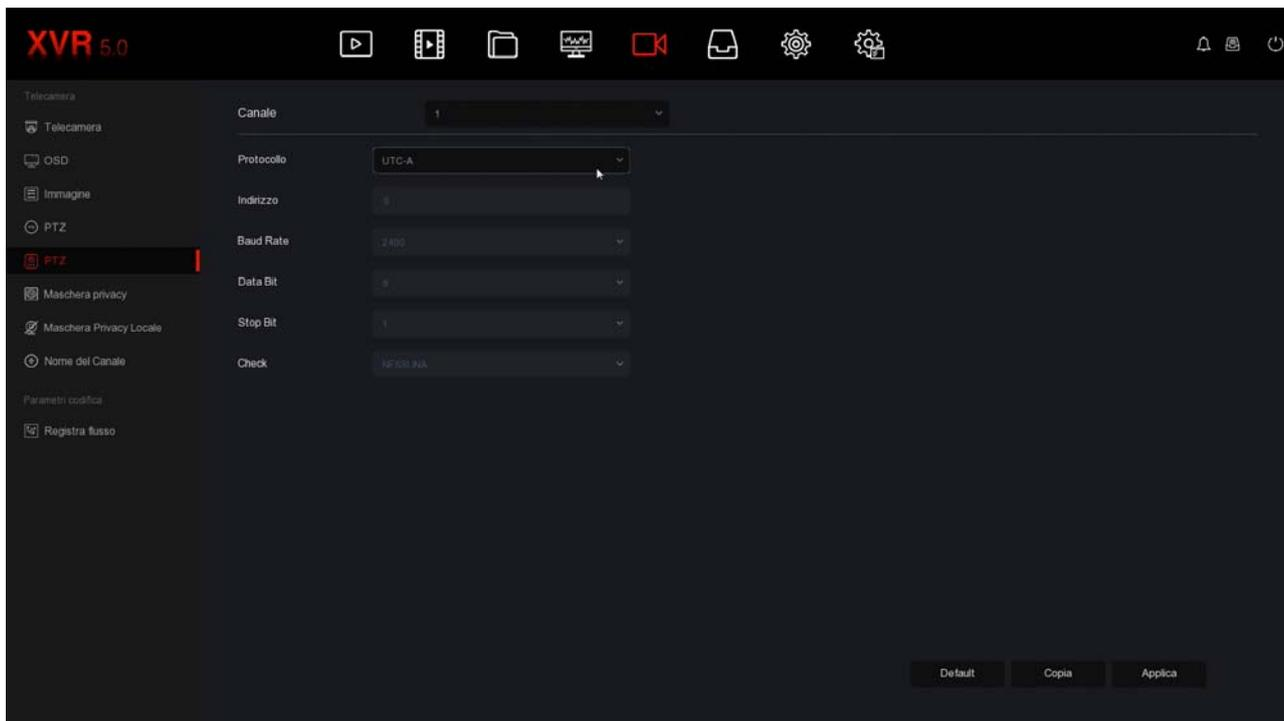
Per controllare il menu OSD della telecamera devi portare la telecamera a pieno schermo, cliccare per far comparire il menu del canale e poi scegliere PTZ per aprire il pannello di controllo PTZ.
