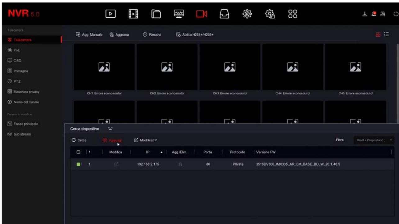
Se la tua telecamera non compare nell'elenco controlla che sia stata configurata sullo stesso segmento di rete del DVR/NVR (nell'esempio qui sopra 192.168.2) e che supporti il protocollo Onvif. Controlla anche le impostazioni di rete del DVR/NVR come visto in precedenza.
