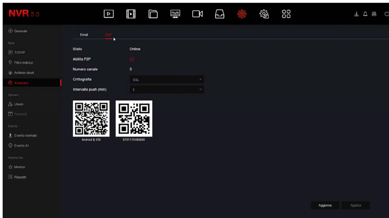
In questa pagina devi controllare che la funzione P2P sia abilitata e che lo stato della connessione al server sia ONLINE, come in questo esempio. Questo significa che l'NVR sta dialogando bene via Internet col nostro server cloud P2P che ti permetterà di accedere via Internet senza configurazioni né IP statico. Se lo stato non risulta ONLINE ma OFFLINE ricontrolla i passi precedenti perché significa che il tuo DVR/NVR non riesce ad accedere alla rete Internet.
