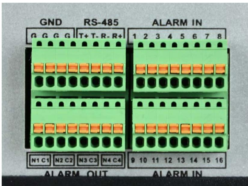
**ALARM IN** – Gli ingressi di allarme servono per collegare contatti esterni che possono attivare allarmi con i quali avviare la registrazione e inviare segnalazioni. Il contatto va collegato fra il morsetto di ingresso (1,2,3,4 etc) e un morsetto GND in morsettiera. Se la morsettiera dispone di più morsetti G o GND puoi sceglierne uno qualsiasi.
